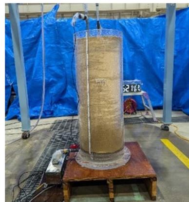
浸透試験における散水の様子
